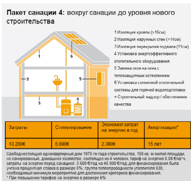
Рис. 62: Всесторонняя модернизация на уровне требований к новому зданию
