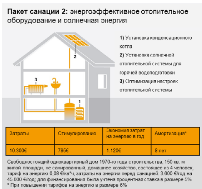
Рис. 60: Пакет модернизационных мер 2 - Эффективная система отопления и солнечная установка
