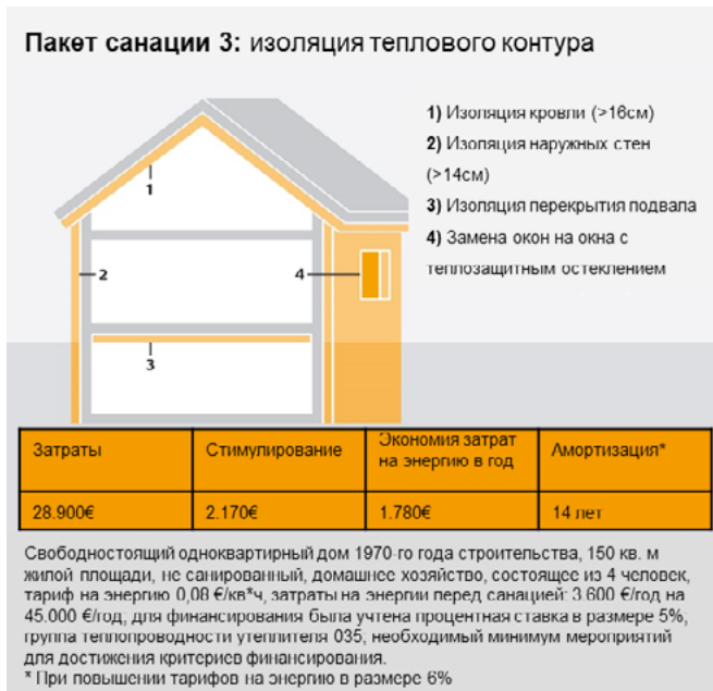
Рис. 61: Пакет модернизационных мер 3 - Теплоизоляция теплового контура здания
