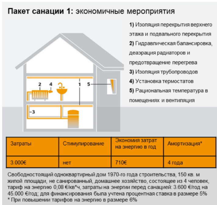
Рис. 59: Пакет модернизационных мер 1 - Малозатратные мероприятия
