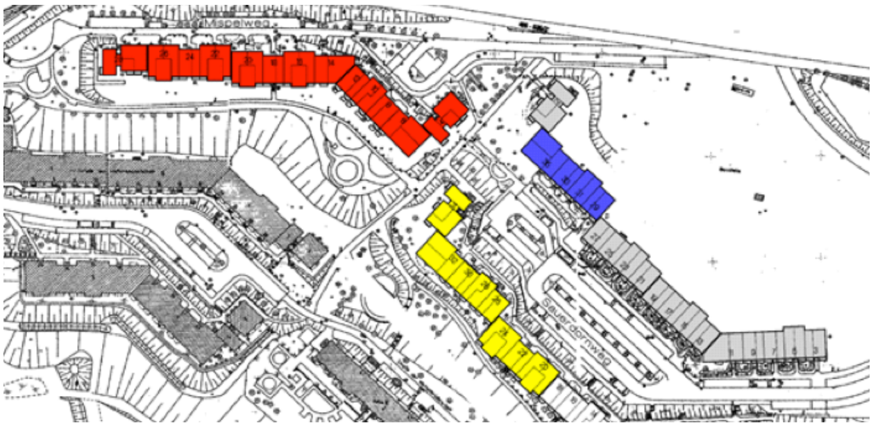
Рис. 31: Здание с приточной и вытяжной вентиляцией и рекуперацией тепла (красный) и только с вытяжной вентиляцией (жёлтый). Источник: ВВР
