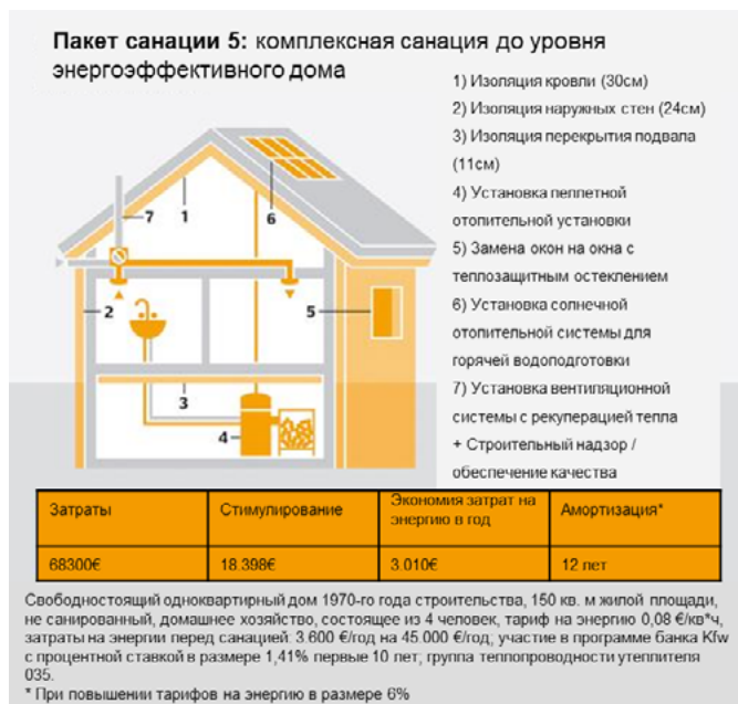
Рис. 63: Полная модернизация на уровне стандарта «Энергоэффективного дома»
