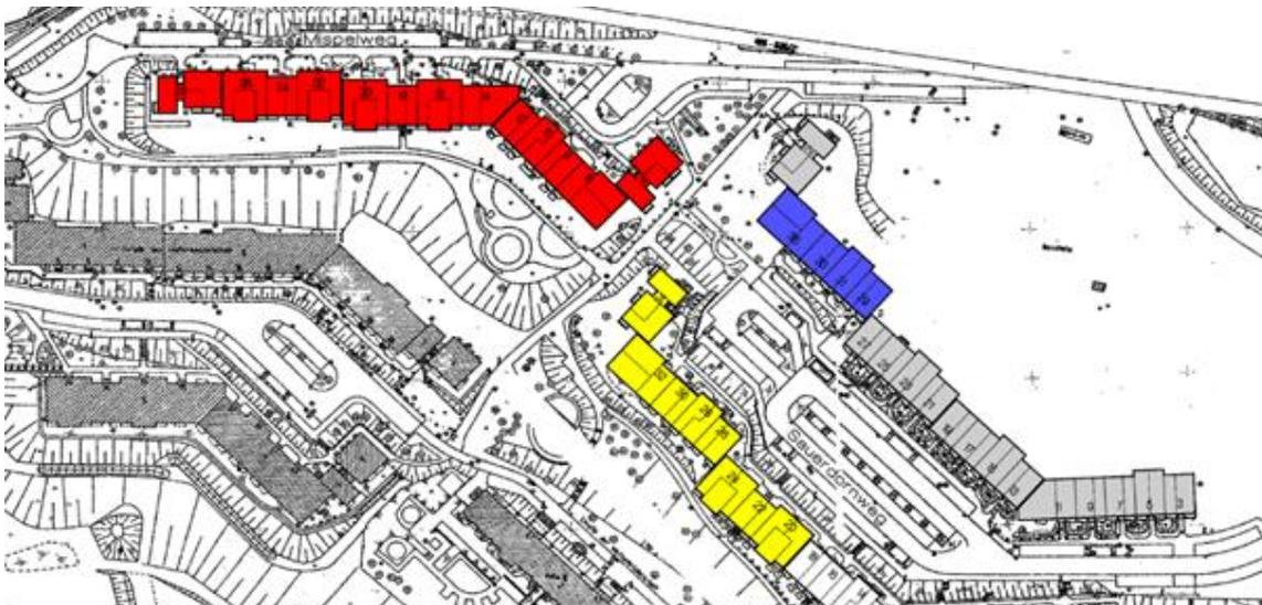
Abbildung 31: Gebäude mit Zu- und Abluft und Wärmerückgewinnung (rot) und nur Abluft (gelb). Quelle: BBP.
