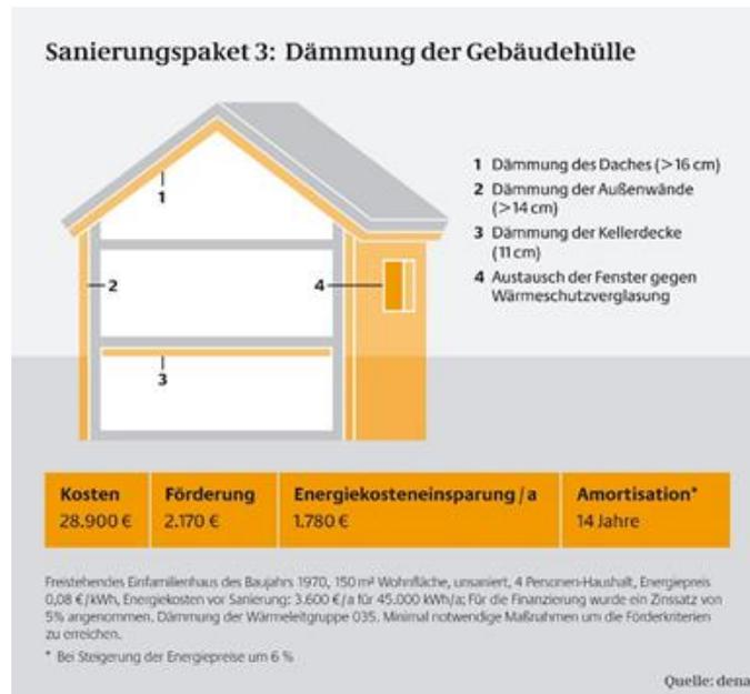
Abbildung 61: Sanierungspaket 3: Dämmung der Gebäudehülle.
