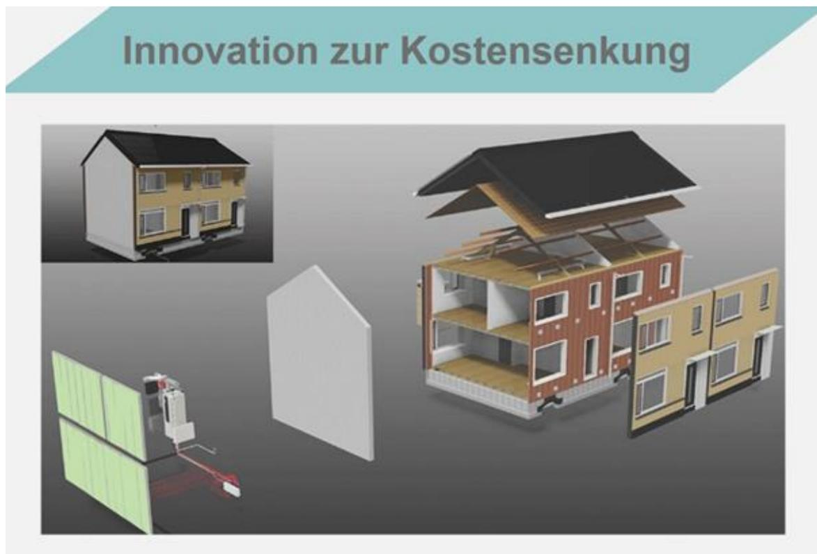
Abbildung 94: Prinzip der industriellen Sanierung.
