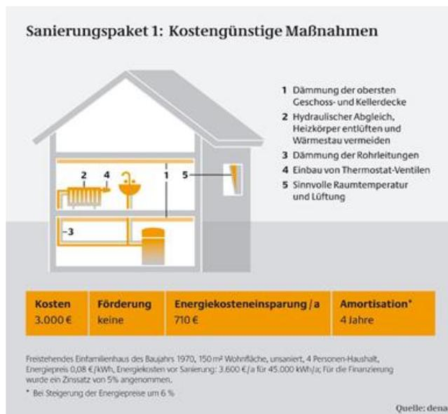
Abbildung 59: Sanierungspaket 1: Kostengünstige Maßnahmen.
