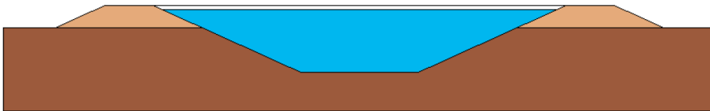
Abbildung 13: Skizze eines Erdbeckenspeichers mit schwimmender Abdeckung (Jensen 2014)
